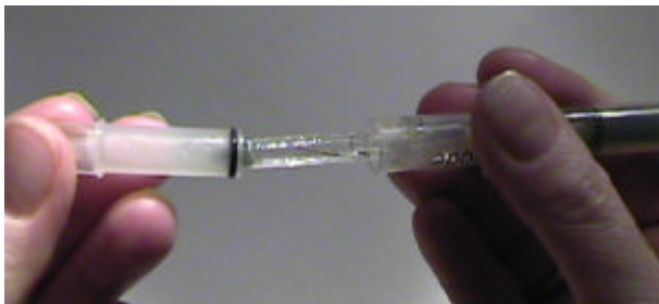
Abziehbare Elektrolytbrücke der G \Delta Tionode ® IJ44
