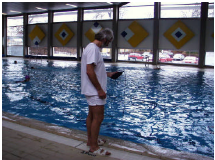
Für die pH-Messung direkt im Becken an eine ausreichende Kabellänge denken.
